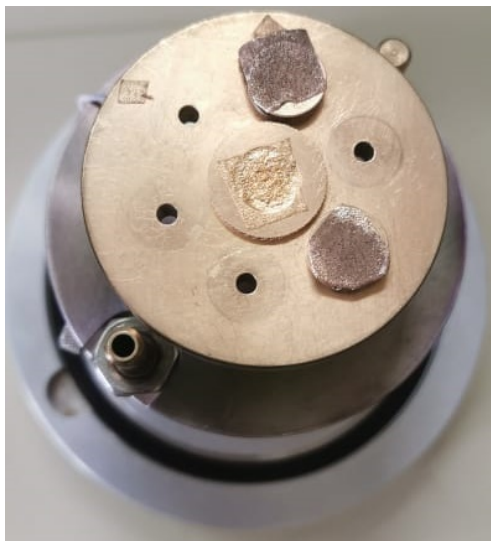
Figura 1. Muestras metalizadas de diatomitas con oro para caracterizar mediante el Microscopio Electrónico de Barrido (SEM)
